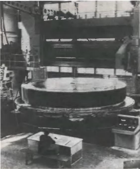
Именно на этом станке, специально изготовленном, проходило обработку зеркало для звезд.
