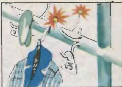
трудно разыскать пустую вешал-ку, она не видна из-за большого количества одежды, — пишет Сергей Жгулев из Горького. — Я предлагаю простое устройство. Надо на каждый крючок вешалки установить низковольтную лам-почку. Крючок же надо подпру-жинить так, чтобы от веса паль-ца лампочка выключалась. Когда же вешалка пустая, лампочка горит».
